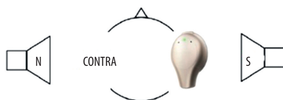
Rycina 3. Położenie źródła sygnału mowy (S) i szumu (N) względem ucha implantowanego (Sentio) oraz ucha przeciwnego (CONTRA)
