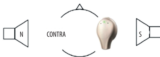
Rycina 3. Położenie źródła sygnału mowy (S) i szumu (N) względem ucha implantowanego (Sentio) oraz ucha przeciwnego (CONTRA)
